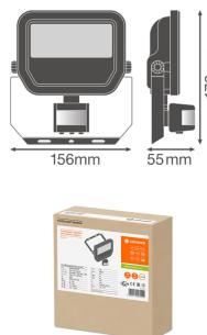
**Scheda tecnica Ledvance Proiettore LED Sensor GEN 3 Nero 20W 2400lm 100D - 840 Bianco Freddo | IP65 - Sensore di movimento e luce - Simmetrico - Sostitutiva 50W**
