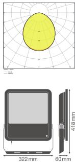
**Scheda tecnica Ledvance Proiettore LED Photocell GEN 3 Nero 165W 20000lm 100D - 840 Bianco Freddo | IP65 - Sensore di luce - Simmetrico**
